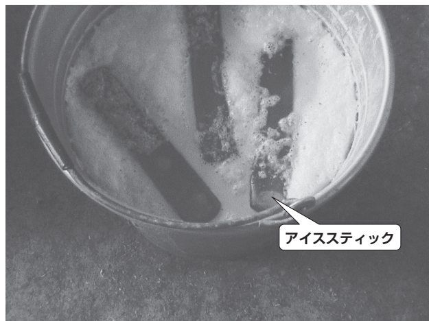
図1 アイススティックを用いた予備冷却
