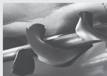
写真2：変形したミキサーカッター
