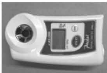
糖度計の例 (ポケットデジタル屈折計APAL-1)
